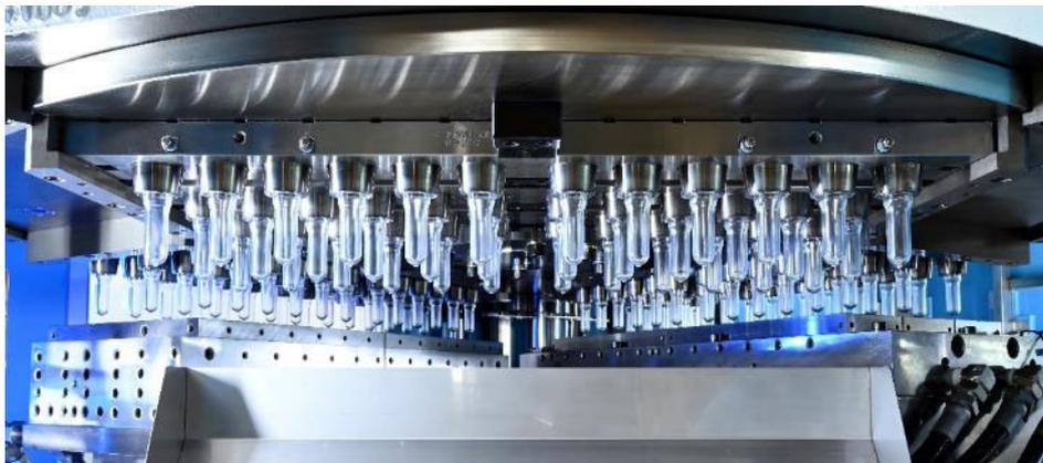
*Imagen 13 - Estación de expulsión de la PM-100/111N mostrando la mesa giratoria con 36 cavidades por estación*
